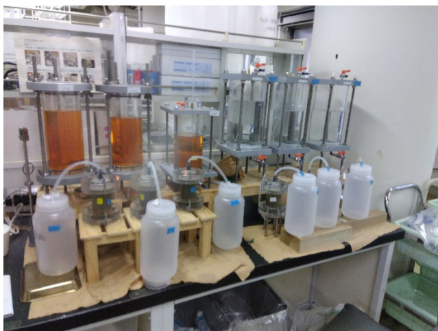
Hydraulic conductivity tests 土の水の通しやすさを評価する実験
