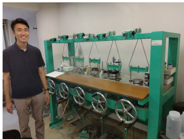
With a consolidation test machine 土を圧縮する実験装置との写真
